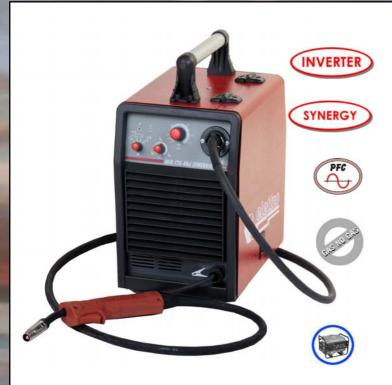
Il s'agit d'un générateur à INVERTER monophasé portatif qui permet de souder à fil MIG-MAG et avec du fil fourré sans protection gazeuse, grâce à l'inversion de polarité.
